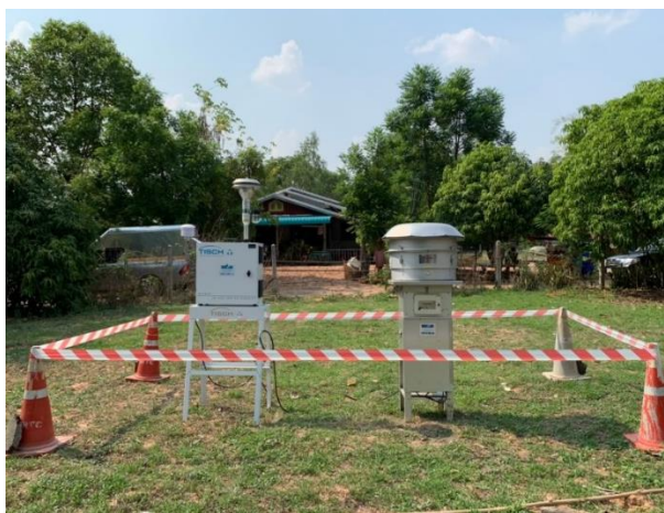
รูปที่ 6-3 เก็บตัวอย่างฝุ่นละอองขนาดไม่เกิน 10 ไมครอนในบรรยากาศทั่วไป ด้วยเครื่องเก็บตัวอย่างอากาศชนิดไฮโวลุ่ม (เครื่องด้านขวา)
