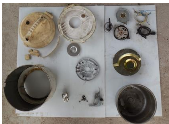
รูปที่ 4-18 ชิ้นส่วนจากการรื้อแยกซากผลิตภัณฑ์เครื่องใช้ไฟฟ้า ประเภทหม้อหุงข้าว
