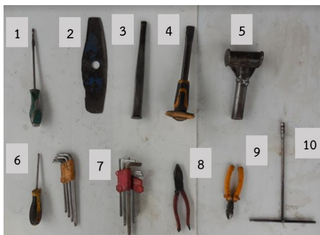
รูปที่ 4-12 อุปกรณ์ที่ใช้ในการรื้อแยกซากผลิตภัณฑ์ฯ ขนาดเล็ก
