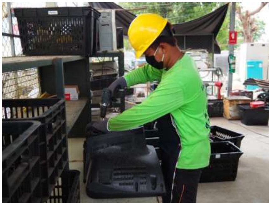
ภาพที่ 4.78 การใช้บล็อกลม (Air Impact Wrench) ชนน็อตแทนการใช้ไขควง
