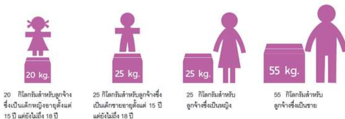
ภาพที่ 4.87 การกำหนดน้ำหนักในการยกด้วยแรงงานคน
