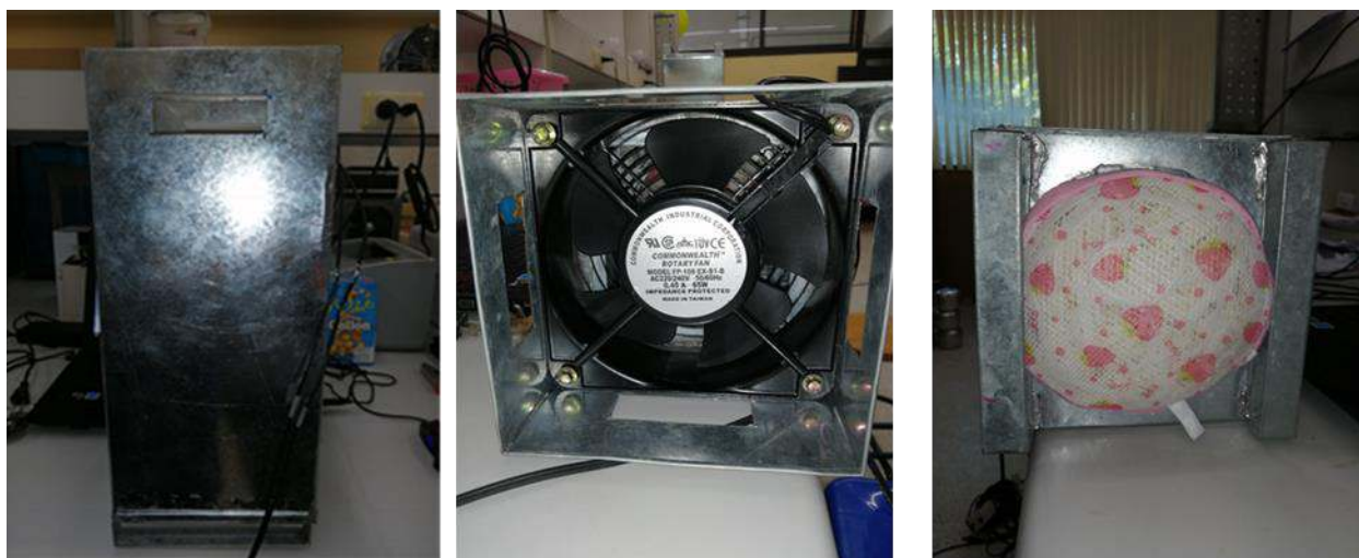
รูปที่ 3-24 เครื่องต้นแบบเครื่องฟอกอากาศแบบไส้กรองทรงกระบอกบรรจุชิ้นส่วนโฟมพียู
