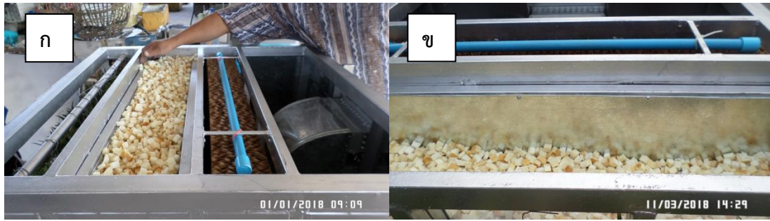
รูปที่ 4-28 โฟมพียูภายในเครื่องกรองไอสารระเหย (ก) การเติมไส้กรองโฟมพียูครั้งแรกที่เติมเต็มช่อง (ข) โฟมพียูเมื่อผ่านการเคลื่อนย้ายและใช้งานมาสักระยะ
