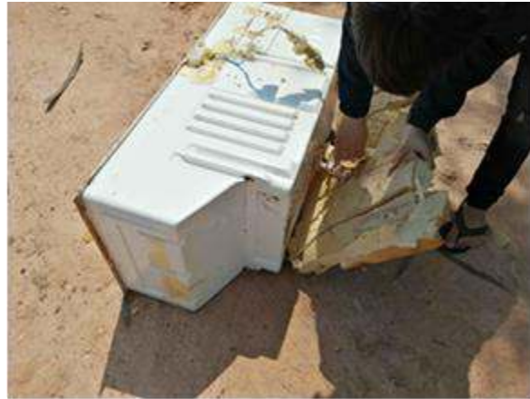
รูปที่ 3-1 วิธีการแยกโฟมพียูออกจากโครงตู้เย็น
