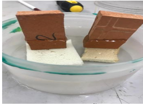
รูปที่ 3-4 การแช่โฟมในน้ำ 24 ชั่วโมง
