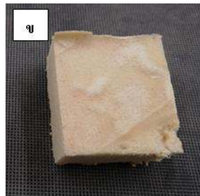
รูปที่ 3-2 ลักษณะกายภาพเชิงประจักษ์ของ (ก) โฟมพียูที่จัดเก็บไม่ถูกแดด และ (ข) โฟมพียูที่ถูกแดดลม
