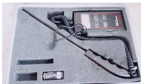
รูปที่ 3-32 เครื่องวัดความเร็วลมแบบ Pitot Tube
