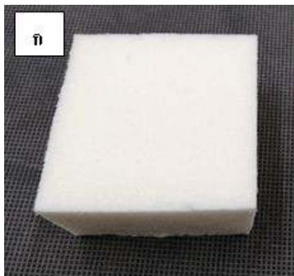
รูปที่ 3-2 ลักษณะกายภาพเชิงประจักษ์ของ (ก) โฟมพียูที่จัดเก็บไม่ถูกแดด และ (ข) โฟมพียูที่ถูกแดดลม
