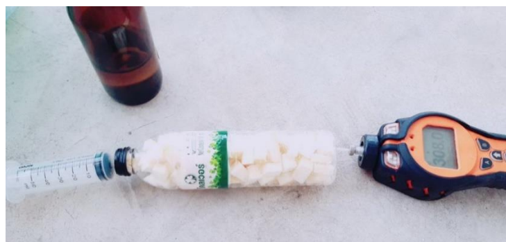
รูปที่ 4-10 การทดสอบหาระยะเวลาการดูดซับไอสารระเหย (Contact time)
