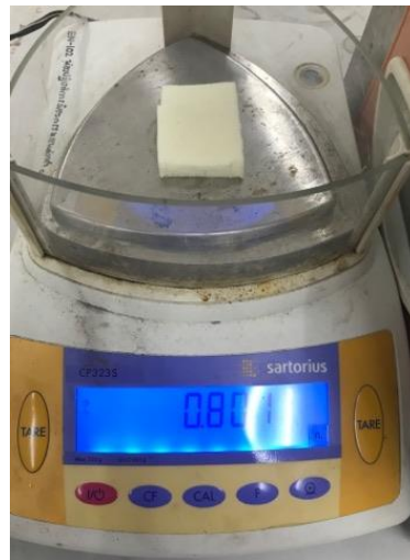
รูปที่ 3-5 การชั่งน้ำหนักก่อนและหลังแช่น้ำ
