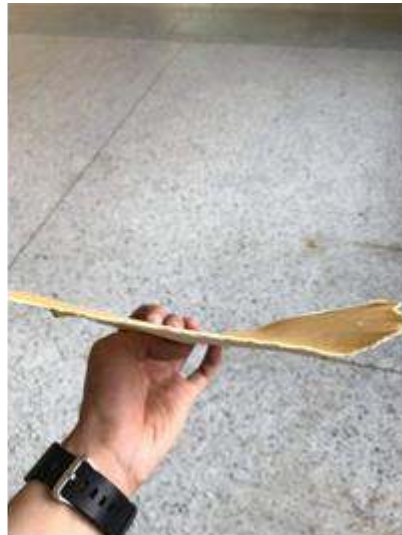
รูปที่ 3-14 แผ่นโฟมพียูที่ตัดด้วยเส้นลวดให้ความร้อน
