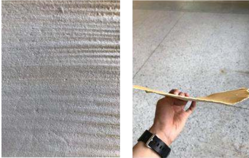
รูปที่ 3-14 แผ่นโฟมพียูที่ตัดด้วยเส้นลวดให้ความร้อน
