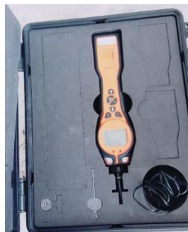
รูปที่ 3-31 เครื่องวัดไอสารระเหยแบบ Photo Ionized Detector
