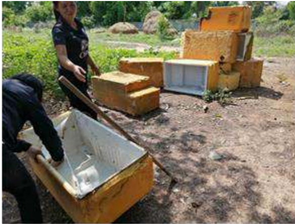
รูปที่ 3-1 วิธีการแยกโฟมพียูออกจากโครงตู้เย็น
