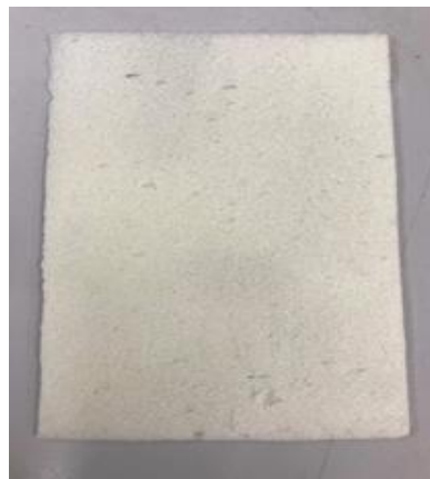
รูปที่ 3-15 แผ่นโฟมพียูที่ตัดด้วยใบมีด
