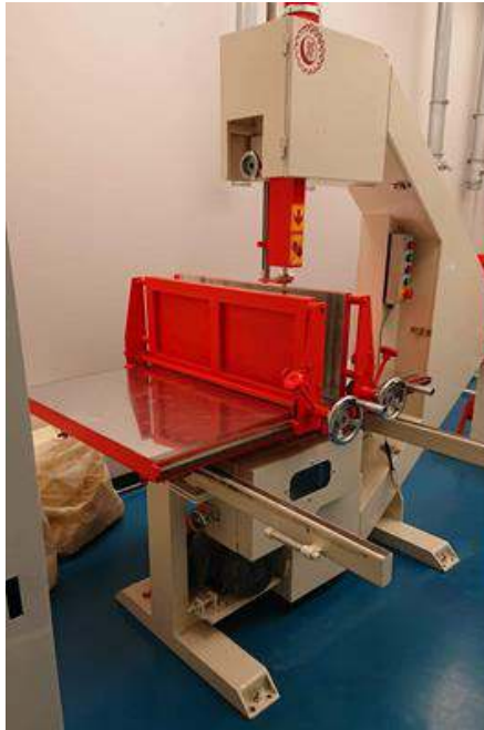
รูปที่ 3-16 เครื่องจักรตัดโฟม (บริษัท ปตท. จำกัด)
