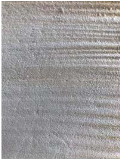
รูปที่ 3-14 แผ่นโฟมพียูที่ตัดด้วยเส้นลวดให้ความร้อน
