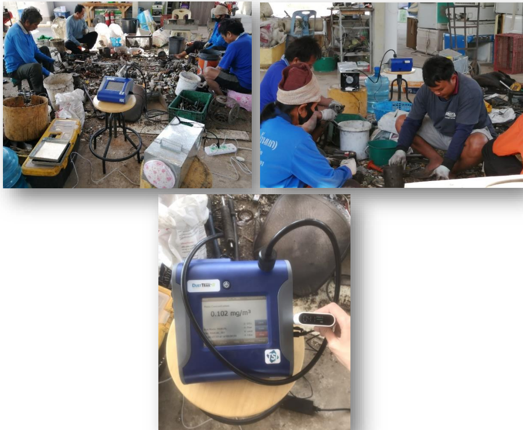
รูปที่ 4-3 การทดสอบเครื่องฟอกไส้กรองทรงกระบอก ณ ร้านผู้ประกอบการคัดแยกขยะอิเล็กทรอนิกส์ ตำบลแดงใหญ่ อำเภอบ้านใหม่ไชยพจน์ จังหวัดบุรีรัมย์
