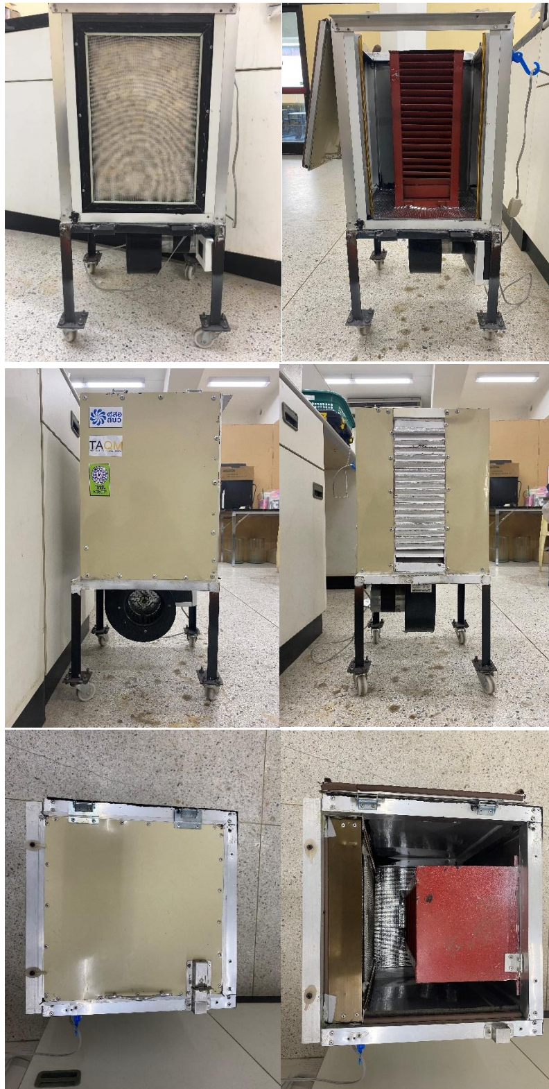
รูปที่ 3-26 เครื่องฟอกอากาศทรงตู้ที่สร้างเสร็จ
