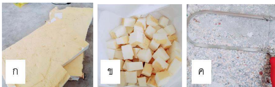
รูปที่ 4-7 การตัดแผ่นโฟมพียู (ก) วัตถุดิบแผ่นโฟมพียู (ข) โฟมพียูที่ตัดแล้ว (ค) เลื่อยฉลุมือ
