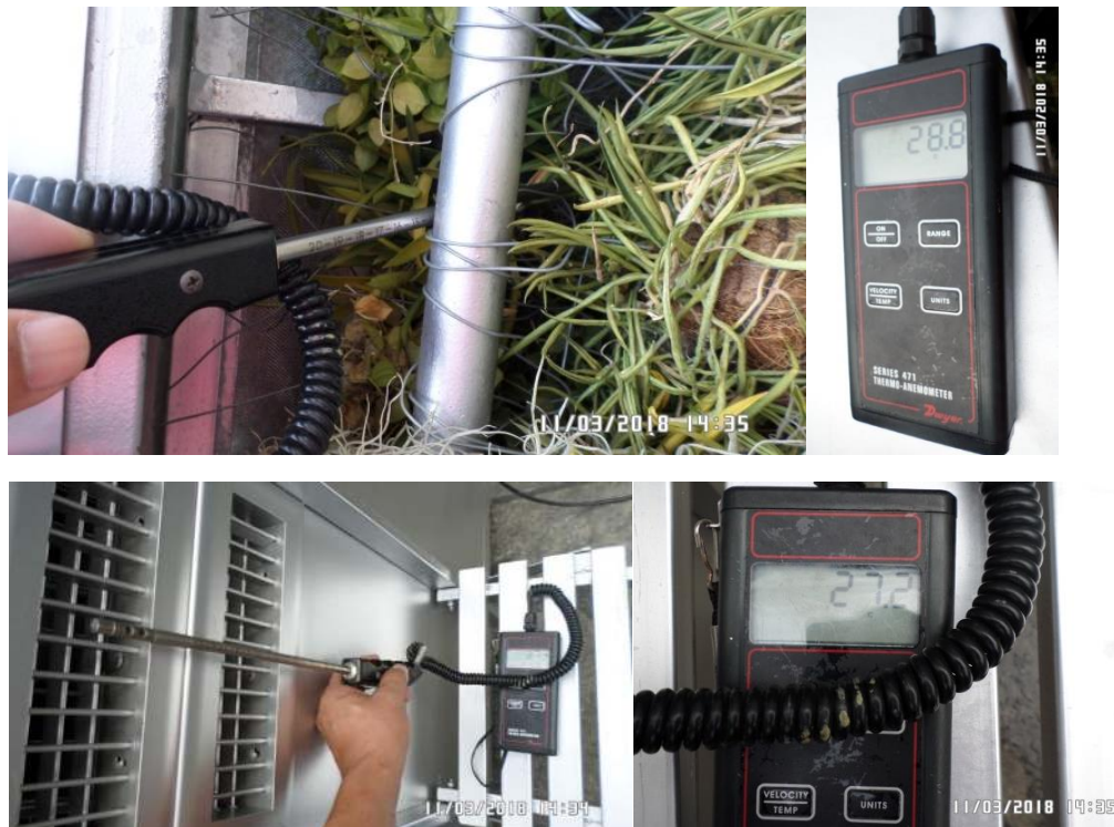
รูปที่ 4-21 การทดสอบการลดอุณหภูมิของเครื่องกรองไอสารระเหย
