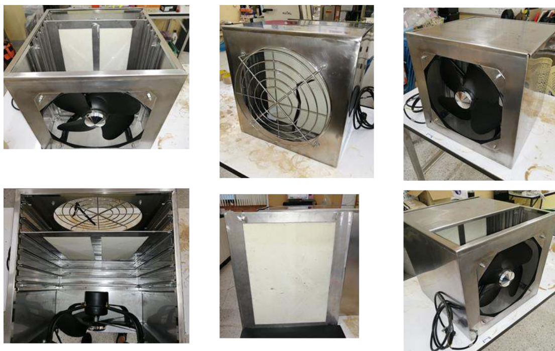
รูปที่ 3-13 เครื่องต้นแบบเครื่องฟอกอากาศแบบไส้กรองแผ่นโฟมพียู
