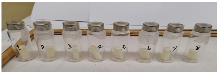
รูปที่ 3-8 การเตรียมตัวอย่างการทดสอบไอโซเทอมการดูดซับ
