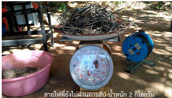
รูปที่ 4-20 เศษสายไฟฟ้าสำหรับการทดสอบเครื่องคัดแยกทองแดง จำนวน 2 กิโลกรัม (ถาดเหล็กหนัก 1 กิโลกรัม)
