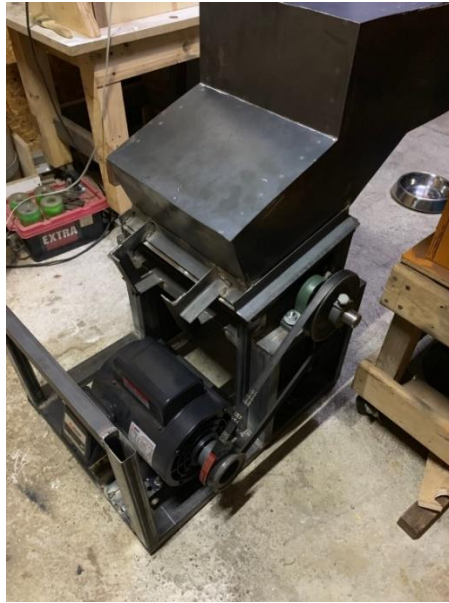
รูปที่ 4-6 โครงภายในเครื่องย่อยเศษสายไฟฟ้า ระดับเครื่องต้นแบบ (Pilot scale)
