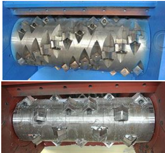
รูปที่ 2-13 ใบมีดตัดหรือบดสายไฟ เครื่องแกรนูลเลเตอร์ (Wanrooe machinery, 2019)
