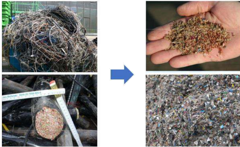
รูปที่ 2-15 การตัดเศษสายไฟฟ้าด้วยเครื่องแกรนูลเลเตอร์ รุ่น Universal Granulator UG600 (Mewa Recycling Anlagen, 2019)
