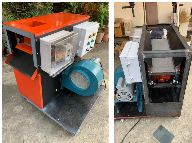
รูปที่ 4-25 เครื่องคัดแยกทองแดงที่ทำการปรับปรุงแก้ไขแล้ว
