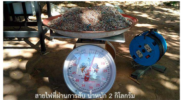
รูปที่ 4-20 เศษสายไฟฟ้าสำหรับการทดสอบเครื่องคัดแยกทองแดง จำนวน 2 กิโลกรัม (ถาดเหล็กหนัก 1 กิโลกรัม)
